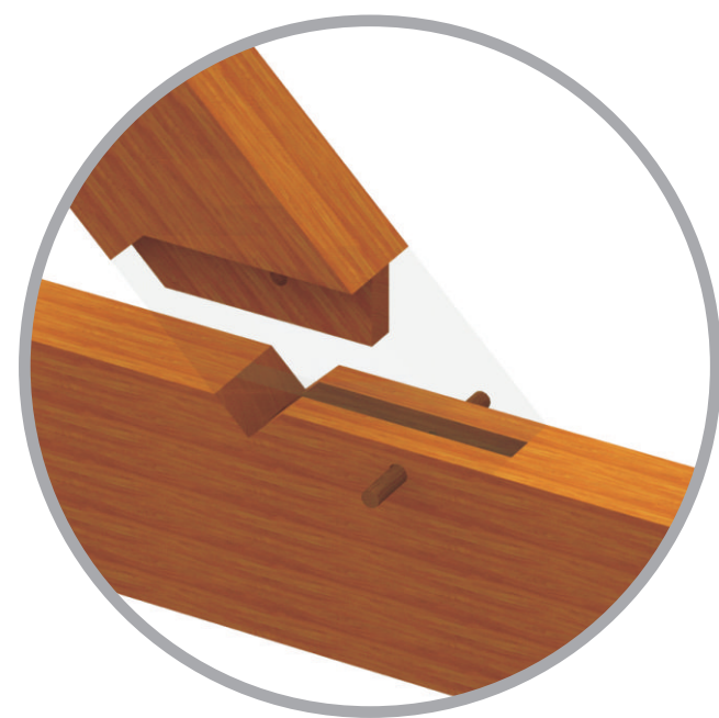
giunto tallone ad angolo retto con tenone
