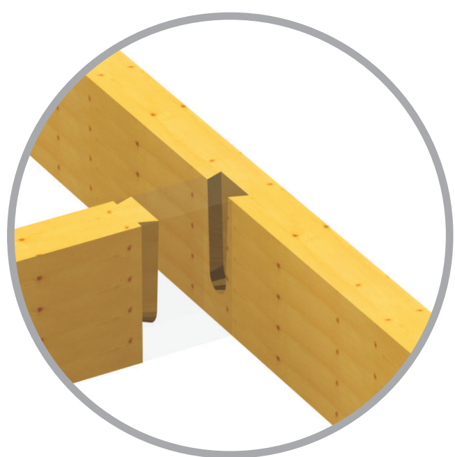
tenone a coda di rondine
